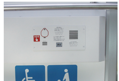
非常通報装置
